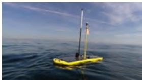
Le Wave Glider est un capteur flottant qui prend des mesures de la vie marine et de la chimie de l'océan. Ce drone naval à énergie solaire et à la portée illimitée peut inspecter la vie marine du fond de l'océan pendant des mois et envoyer les données recueillies à Dalhousie par satellite en temps réel.
